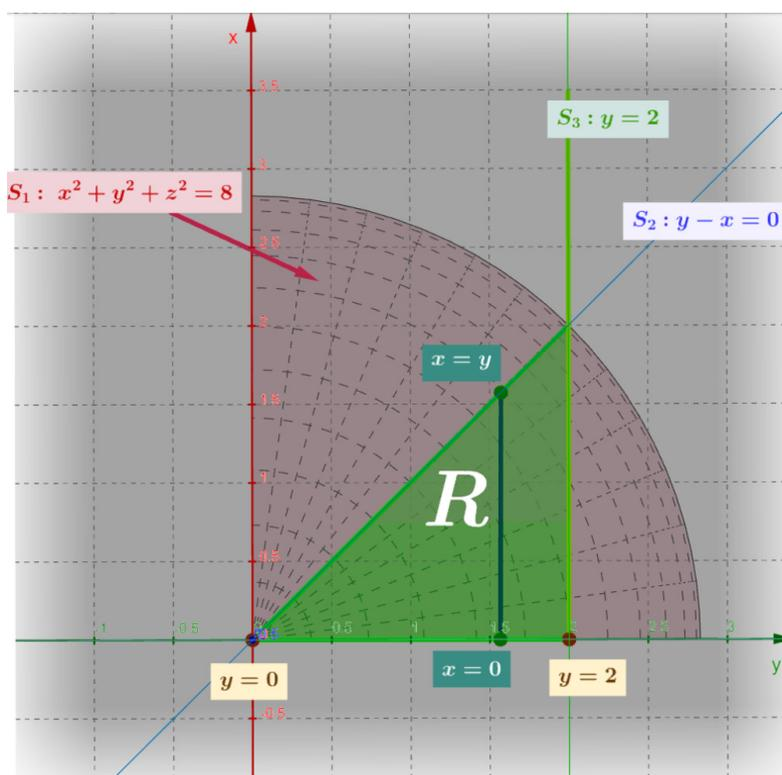
**Figura 3:** Región  $R$  en el plano  $xy$ . Se ilustra cómo definir los límites considerando primero la variación de  $y$ . Si  $y$  se mueve entre 0 y 2 (sus límites constantes), entonces para cada valor de  $y$ ,  $x$  varía desde la recta  $x = 0$  (eje  $y$ ) hasta la recta  $x = y$  (etiquetas verdes). Esto lleva a la descripción:  $0 \leq y \leq 2$ ,  $0 \leq x \leq y$ . **Explora en 3D:** [GeoGebra Link](#)
